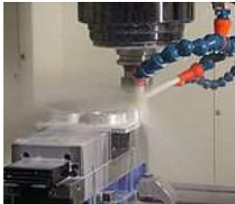
Generando residuos sólidos y partículas en suspensión en los fluidos refrigerantes en la conformación por arranque de viruta
